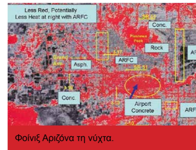
Οι θερμοκρασίες κατά τη διάρκεια της νύκτας εμφανίζονται χαμηλότερες στην επιφάνεια της τροποποιημένης με ελαστικό ασφάλτου
